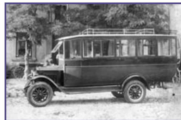
Chevrolet z roku 1925 to przykład klasyki i elegancji nadwozi autobusowych. Mimo, że 4 cylindrowy silnik posiadał moc ok. 45 KM wystarczało to jednak na rzewóz 24 pasażerów.
