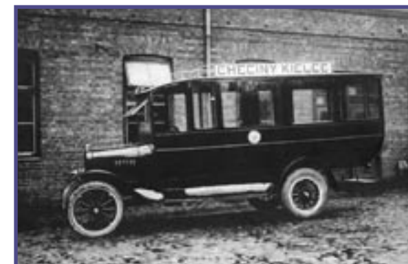
Ten autobus zabierał niespełna 20 pasażerów, a zbudowany był na wydłużonym podwoziu Forda.
